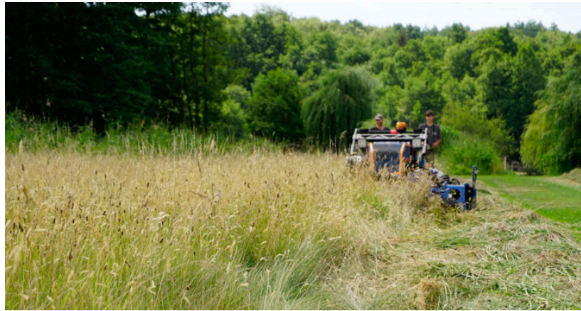
Probemahd mit einem ferngesteuerten „Geräteträger“ von IRUS Foto: G. Richter
