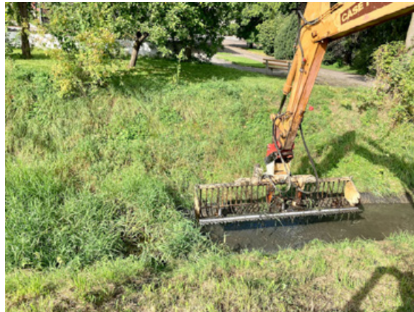
Sohlentkrautung und Mähen – ein Arbeitsgang. Foto: J. Gerhardt/LPV Regensburg.
